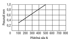
Posunutí při statickém zatížení z jedné strany
